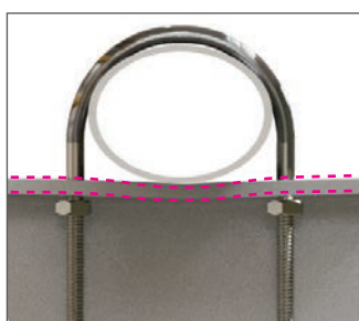
Uボルトの締め付けすぎで鋼材が変形
