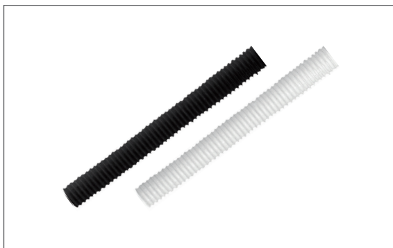
全ねじ「パウダーコーティング」 仕様：全ねじの全面コーティング ネジ切り部もナットが通る厚みでのコーティング
